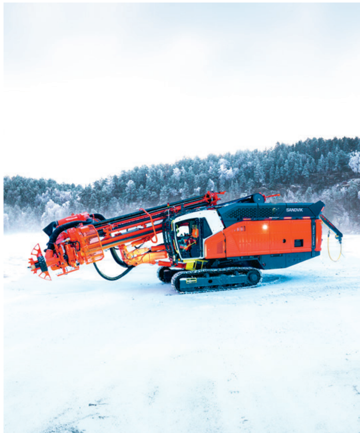
Den nya batterielektriska borriggen flyttar fram gränserna mot utsläppsfri gruvdrift ovan jord.
