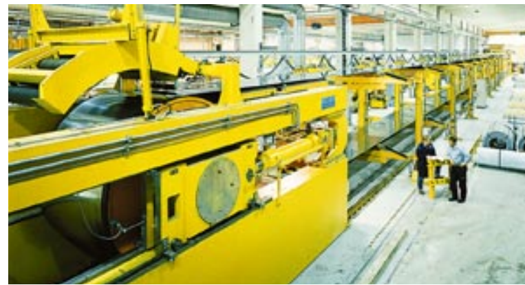
UNDER ÅRET INSTALLERADES EN NY RIKTNINGSANLÄGGNING FÖR STÅLBAND I SANDVIKEN.
