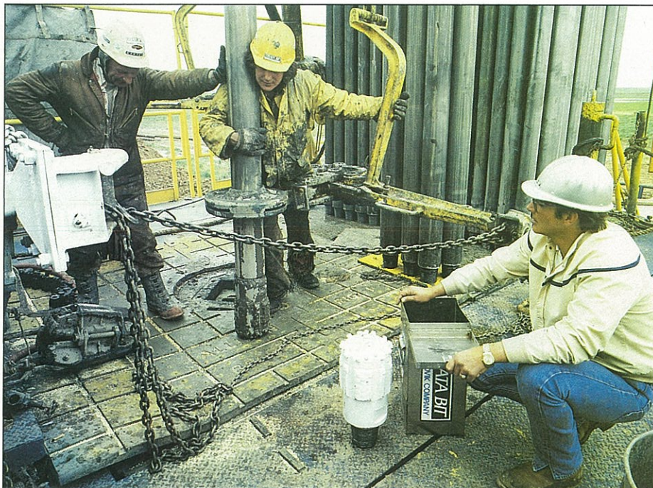
Borkronor för olje- och gasindustrin är ett av Sandvik Rock Tools nya verksamhetsområden. Det amerikanska dotterbolaget Strata Bit har utvecklat en speciell borkrona med skär av industridiamant.
