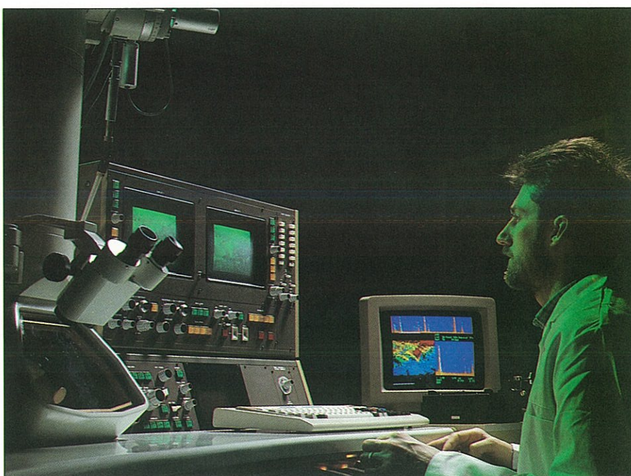
Sandviks stålforskningscentrum i Sandviken har ett nytt transmissionselektronmikroskop som kan förstora upp till 850.000 gånger och som är utrustat med modern kemisk analysmöjlighet.
