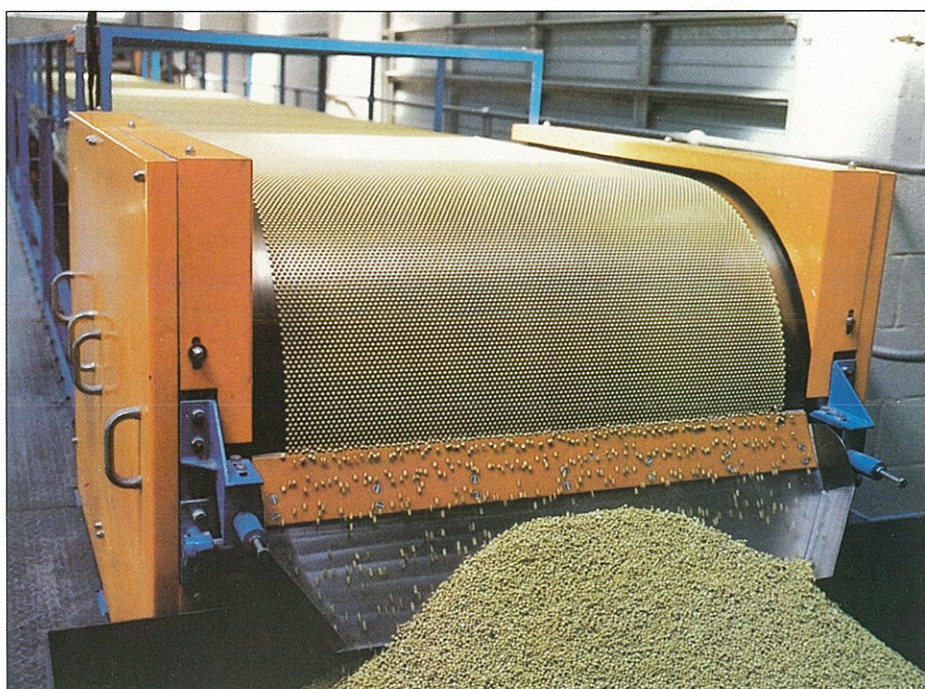
Sandvik Process Systems goda resultat 1985 beror till stor del på ökade leveranser av Rotoform-anläggningar. Bilden visar en anläggning för kylning och pastillering av vax hos en kund i England.
