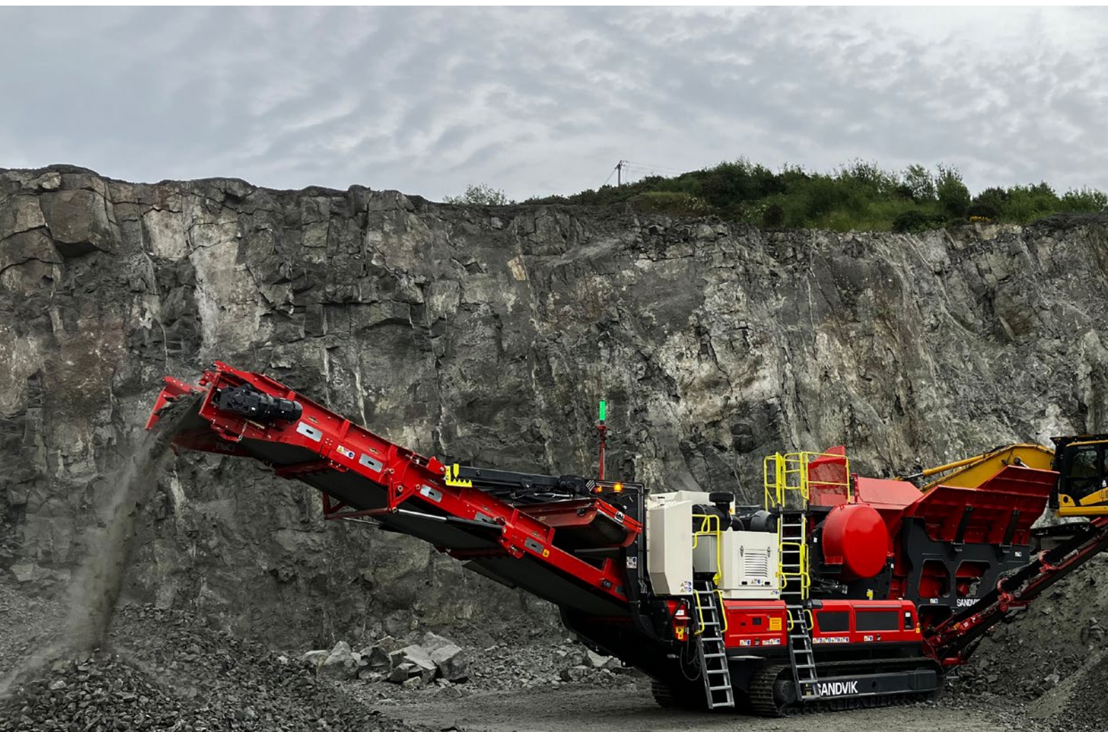
Käftkrossen UJ443E är helt elektrisk och utformad med säkerhet, produktivitet och hållbarhet i fokus.
