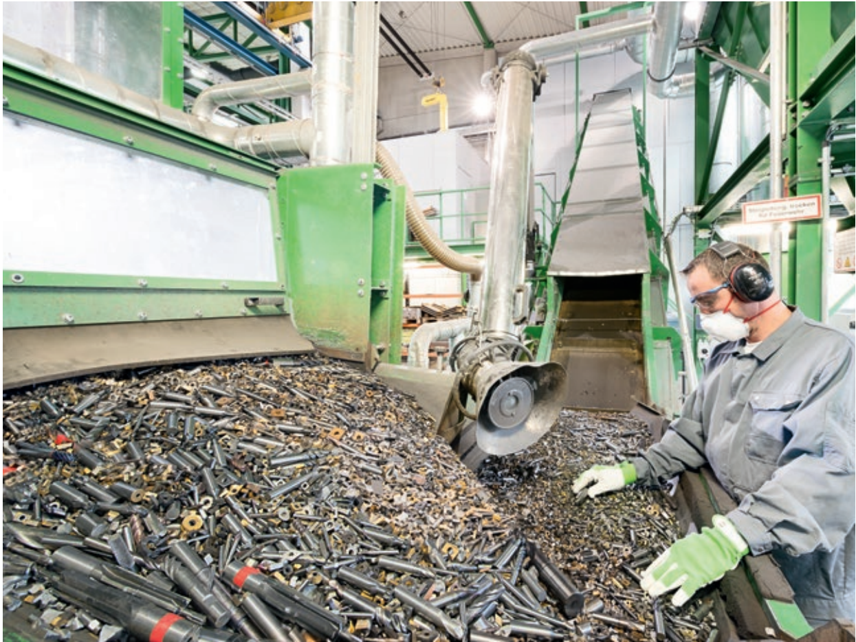
Återvinning av hårdmetaller på Wolfram Bergbau und Hüttens anläggning i St. Martin, Österrike.
